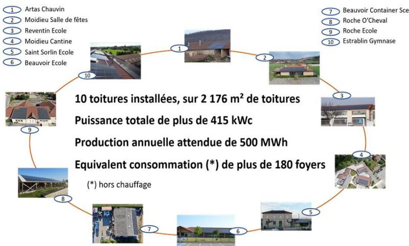
**Quelques chiffres :** Le potentiel des panneaux photovoltaïque de la première tranche est de l'ordre de **415 kWc**. Cela correspond à une production annuelle de 500 000 kWh (500 MWh). Cette production équivaut à la **consommation de 180 foyers hors chauffage électrique**.
